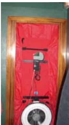
Porte soufflante utilisée pour le test d'étanchéité à l'air
